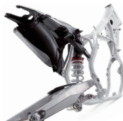
Due differenti importanti rispetto alle KTM, il sistema leveraggio e il telaio posteriore in materiale composito.
